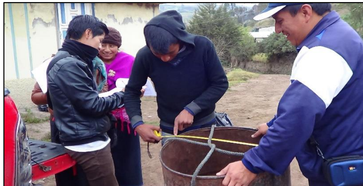
Fotografía 5-0. Toma de medida del diámetro del tanque REALIZADO POR: Viñán Lorenzo
