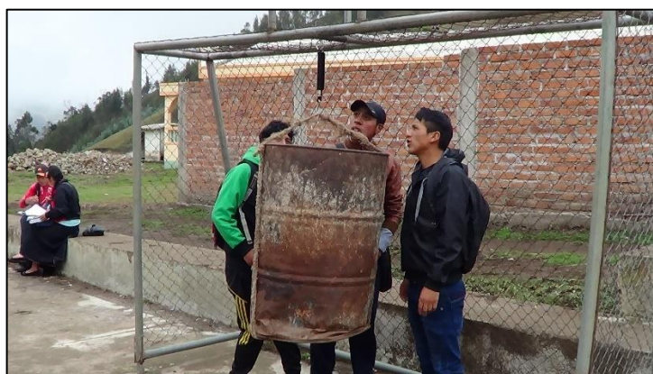
Fotografía 7-0. Pesaje de tanque vacío y con basura para el cálculo de densidad REALIZADO POR: Viñán Lorenzo
