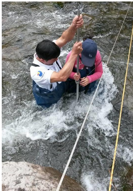
B1: Aforo con molinete SEBA
