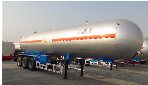
Figura 2-14. Autotanque con bastidor falso Fuente. (CHANGHUA)
