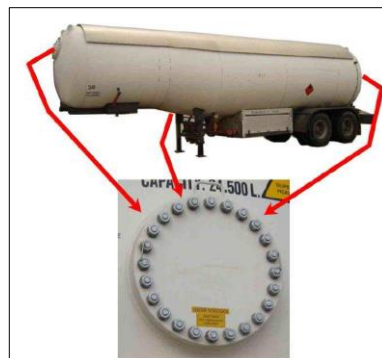
Figura 2-5. Manhole Fuente. (BLESÀ PÈREZ)
