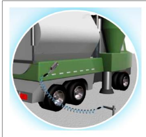
Figura 2-10. Conexión a tierra. Fuente. (DEL REY MARTIN, 2014)
