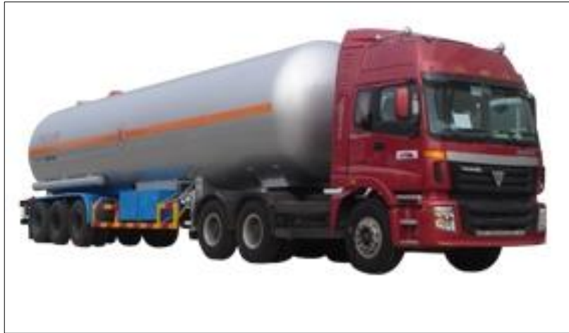
Figura 2-1. Semirremolque tipo tanque cisterna Fuente: (BLESÁ PÉREZ)
