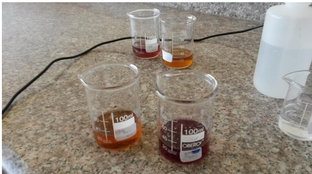
Ilustración 5. Cambio de color de las soluciones acuosas ante la reducción del cromo Fuente: CARRIÓN, Blanca (2016)
