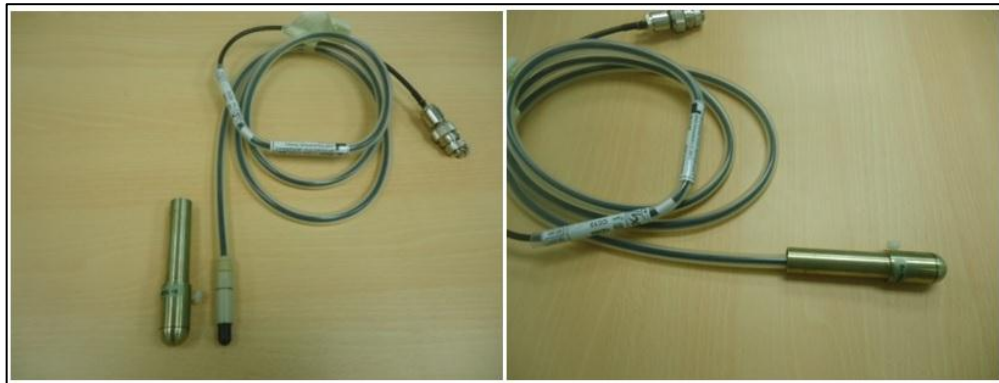
Figura 10-2 Cámara de ionización con build-up para la medición del Sc.
