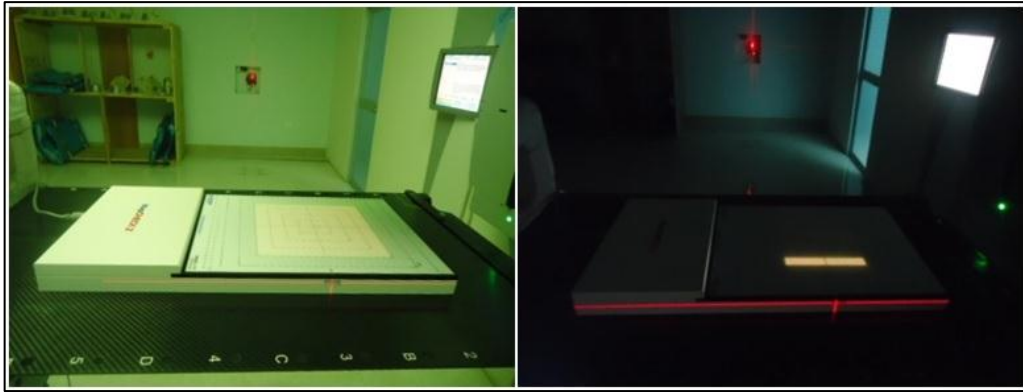
Figura 8-2 Posicionamiento del MapCHECK2 y adquisición de datos – Picket Fence.
