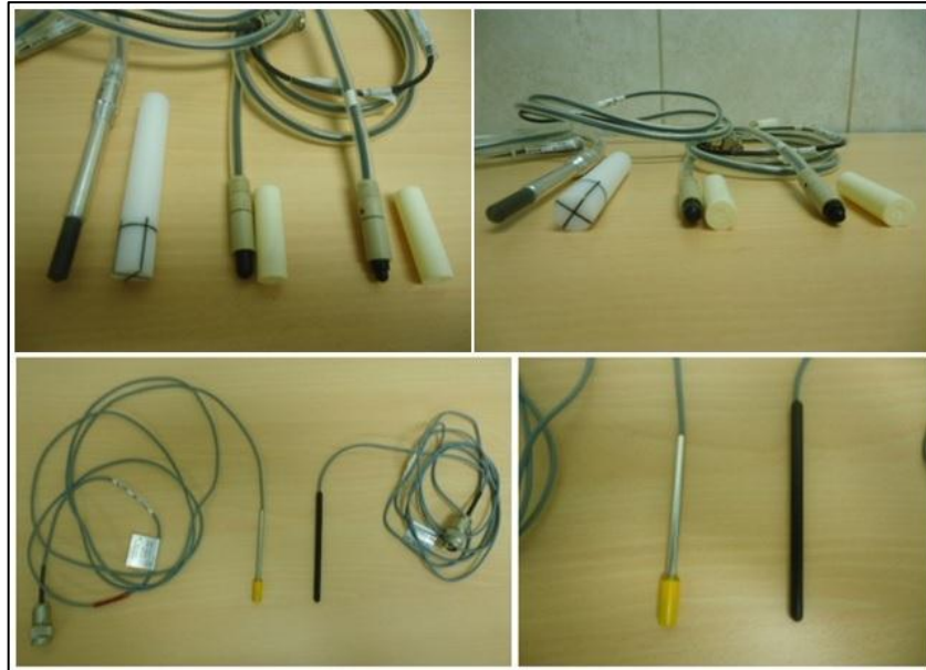
Figura 3-2 Cámaras de ionización y detectores tipo diodo utilizados en la adquisición de medidas.
