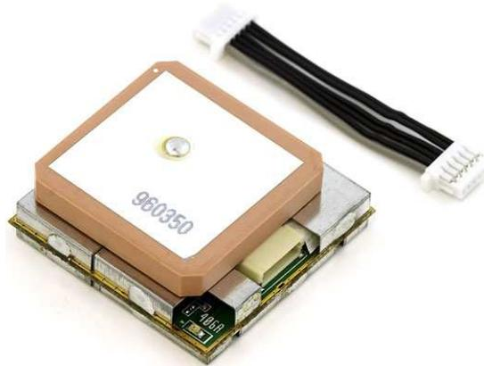
**Figura III.17.** Representación gráfica módulo SiRF III
