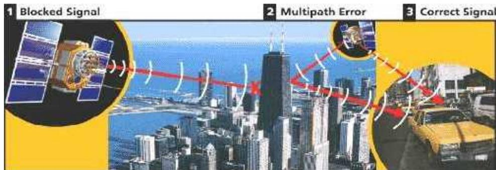
**Figura III.21.** Errores de GPS que muestran una señal bloqueada y una señal multi-camino.
