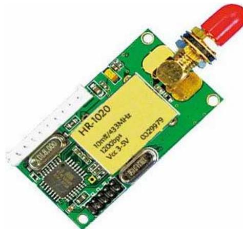
**Figura III.14.** Módulo RF Rx/Tx micro HR-1020
