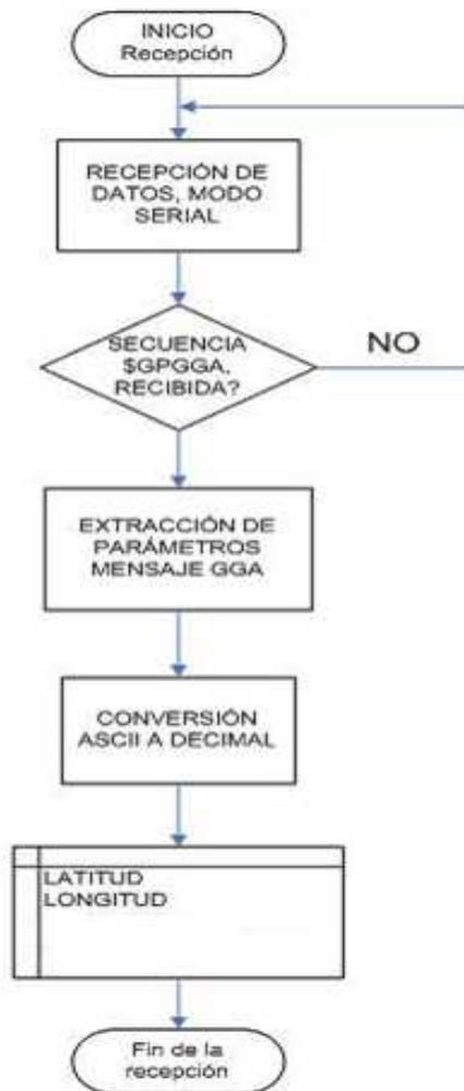
**Figura IV.42.** Algoritmo de lectura de datos del módulo gps
