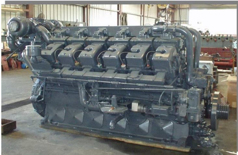
Figura 2-2. WAUKESHA VHP Fuente: REPSOL Bloque 16. EnDyn (2015)
