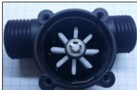
**Figura 2-6: Sensor de flujo YF-S201**
