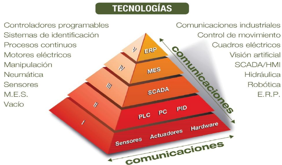
Figura 16-1 Pirámide de Automatización Fuente: www.smctraining.com
