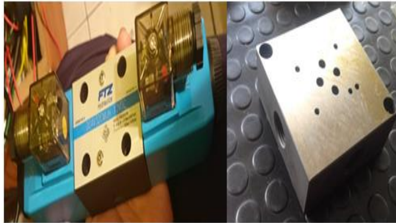
Figura 9-2 Electroválvula FTZ y su placa base de acoplamiento. Fuente: CHANCUSIG, Mario; BALSECA, Alvaro, 2016
