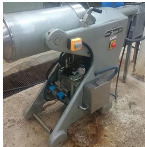
Figura 47-2 Implementación caja de control de válvula y sensor de presión
