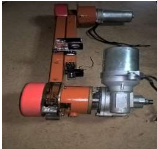
Figura 58.2 Brazo robótico de cuatro GDL
