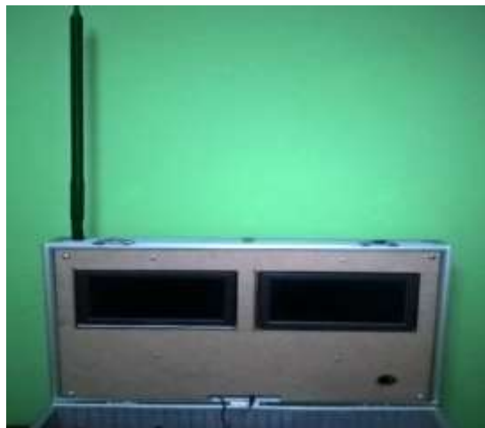
Figura 65.2 Pantallas empotradas en la base de control del robot
