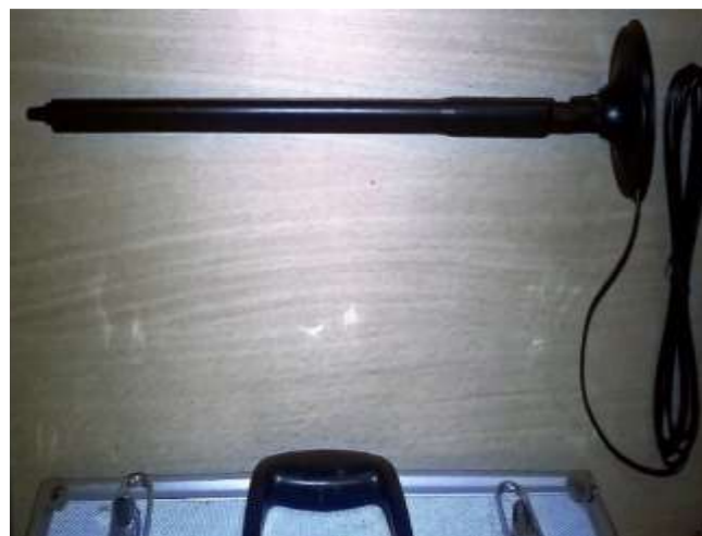
Figura 69.2 Antena de 20 dBi para aumentar la señal de transmisión de la cámara
