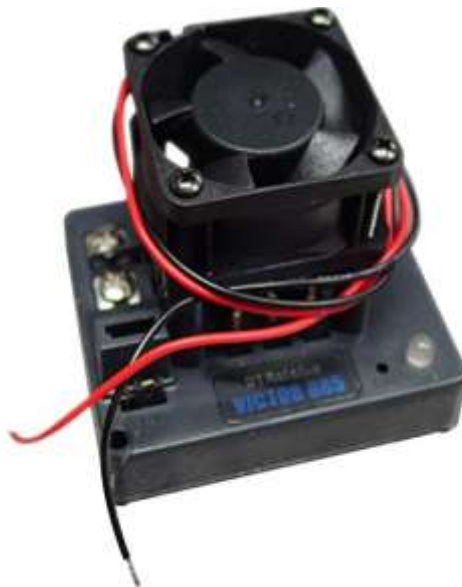
Figura 62.2 Puente H para el control de los motores del robot
