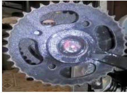
Figura 54.2 Ensamble final del soporte para la tracción de la oruga del robot en forma física
