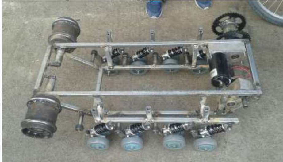
Figura 40.2 .2 Empotrado de la base superior del amortiguador y basa para el Tren de llantas superior a la estructura del robot en forma física
