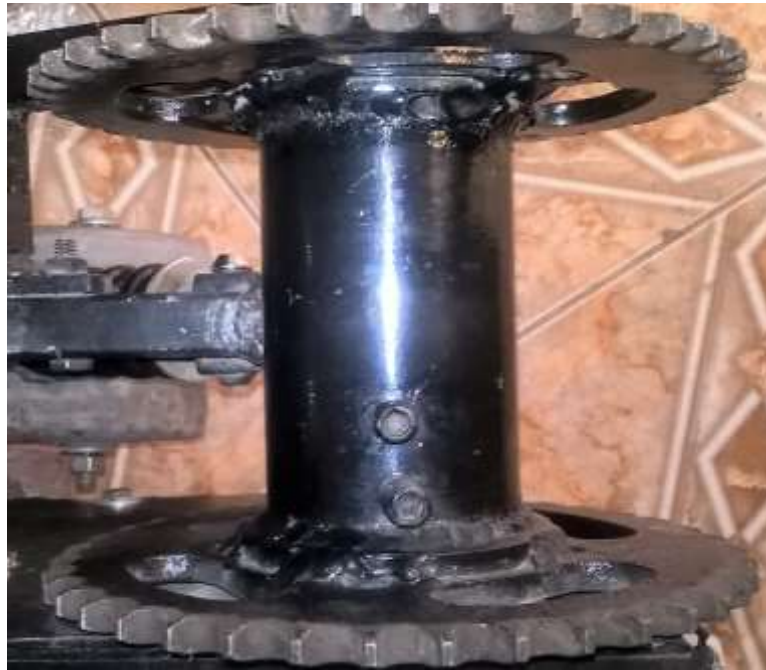
Figura 12.2 Ensamblaje final del sistema de tracción de oruga en forma física Realizado por: Roberto Borja & Hugo Bravo, 2016
