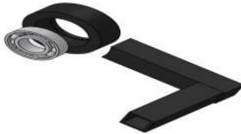
Figura 52.2 Forma de ensamblar el soporte para la tracción de la oruga del robot
