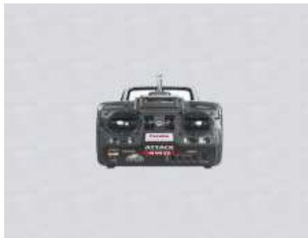
Figura 30.1 Emisora Radiocontrol de 4 canales
