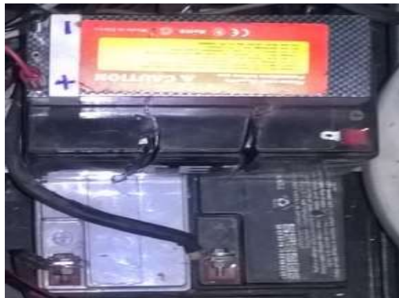
Figura 63.2 Banco de baterías para la alineación de los motores del robot
