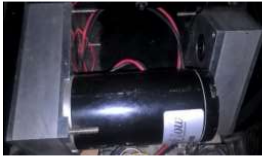
Figura 61.2 Motor dc AmpFlow E30-400 de 24[V] Realizado por: Roberto Borja & Hugo Bravo, 2016
