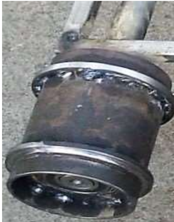
Figura 20.2 Sistema mecánico del rodillo frontal armado en forma física
