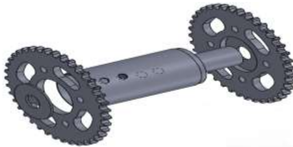
Figura 10.2 Forma de armar el sistema de tracción para oruga
