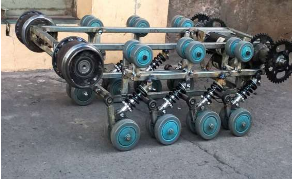
Figura 42.2 Empotrado del tren de llantas superior del robot en forma física Realizado por: Roberto Borja & Hugo Bravo, 2016
