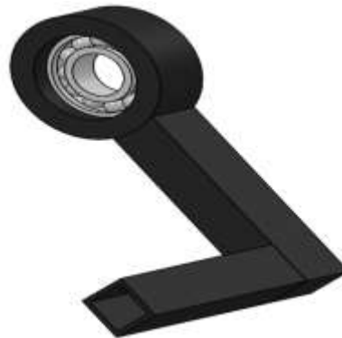
Figura 53.2 Ensamble final del soporte para la tracción de la oruga del robot
