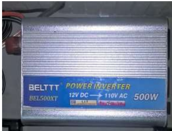
Figura 64.2 Inversor DC- AC de 12 V-110V
