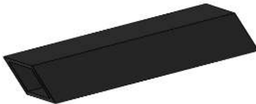
Figura 33.2 Base para empotrar el eje de soporte del tren de llantas al chasis del robot
