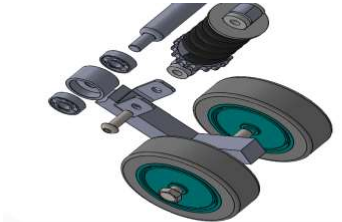
Figura 29.2 Forma de armar el sistema de suspensión del robot
