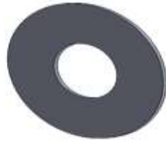
Figura 15.2 Tapa que permite unir los dos cilindros del rodillo
