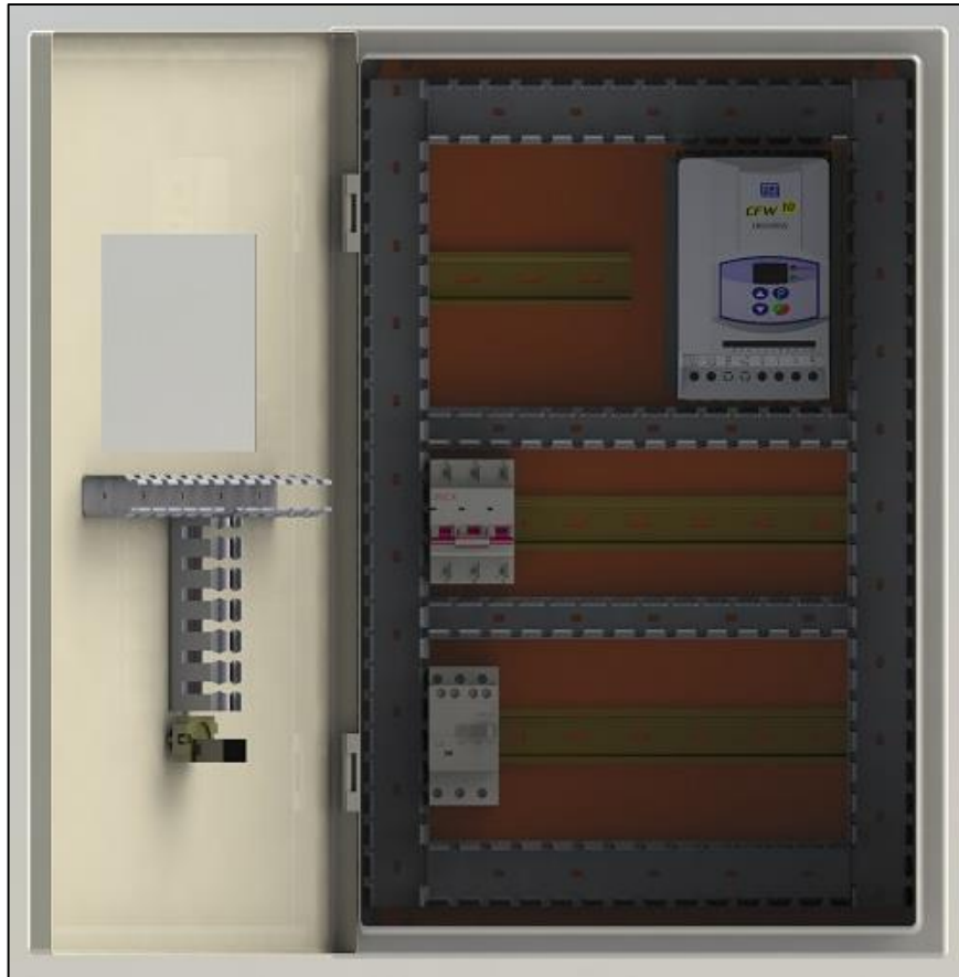
Figura 19-3: Tablero de control con la etapa de fuerza (Variador de Frecuencia)
