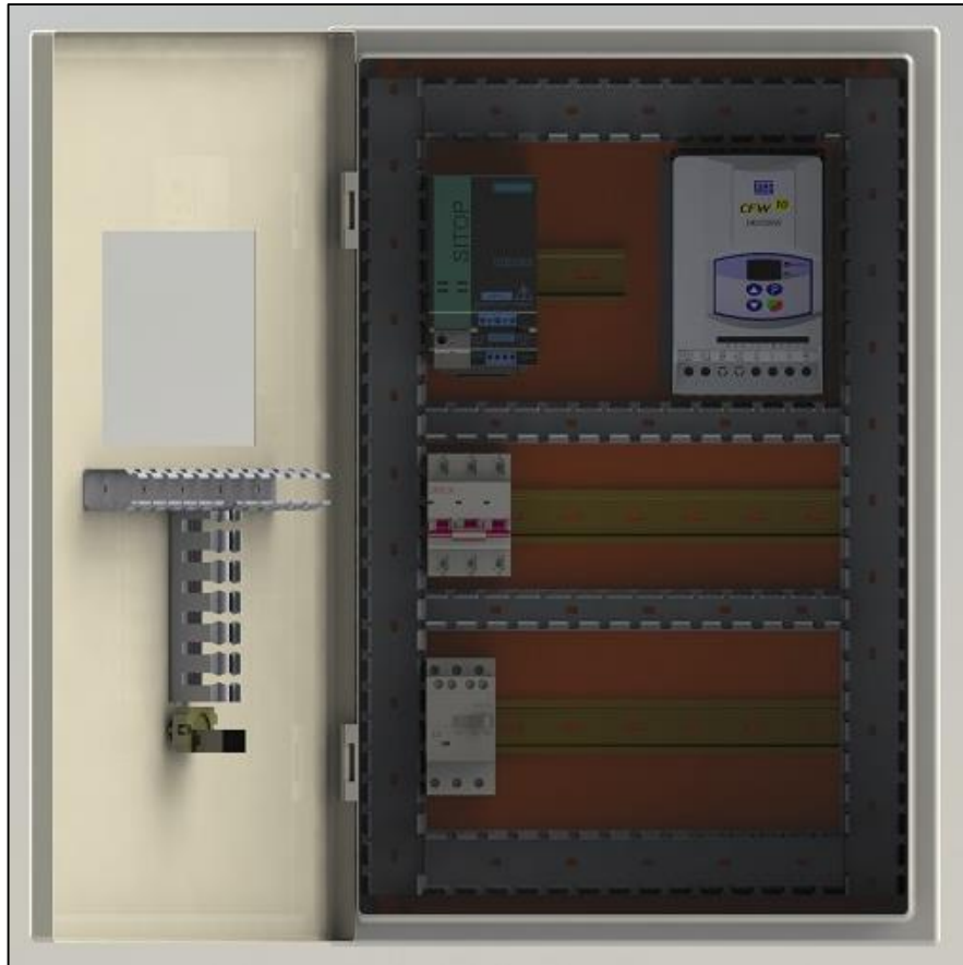
Figura 20-3: Tablero con la fuente de alimentación en DC SITOP 5A Fuente: SILVA CONDE, Angel Alberto, 2016
