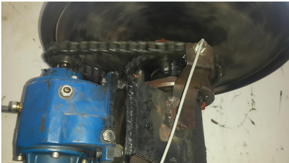
Mecanismo de compuerta con sensor para detección de la posición
