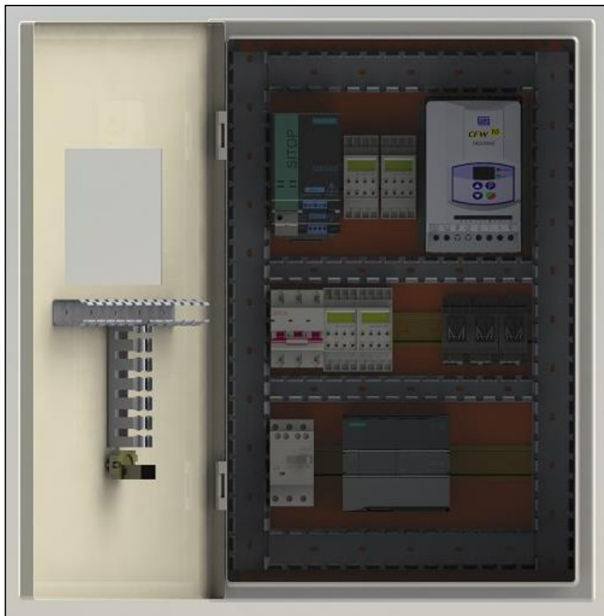
Figura 23-3: Incorporación de un PLC al tablero de control Fuente: SILVA CONDE, Angel Alberto, 2016
