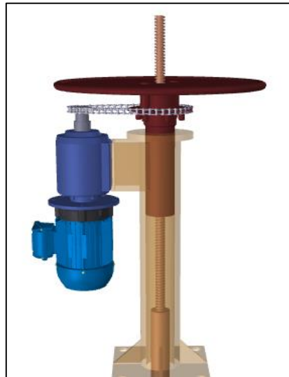
Figura 7-3: Válvula de compuerta con motorreductor Fuente: SILVA CONDE, Angel Alberto, 2016
