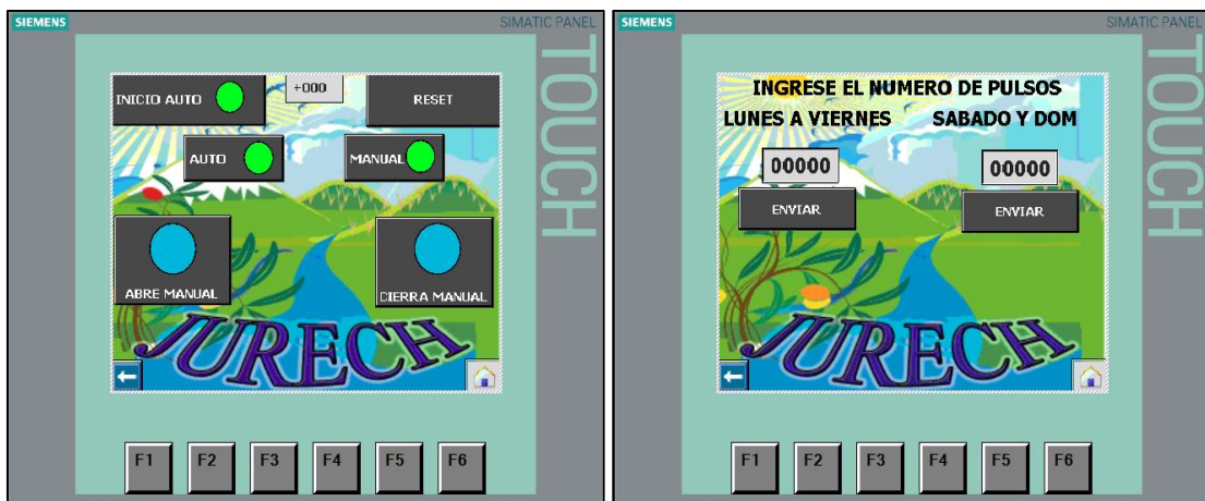
Figura 46-3: Menú de control del sistema automático Fuente: SILVA CONDE, Angel Alberto, 2016
