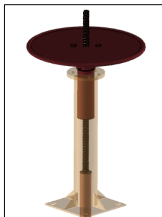
Figura 6-3: Válvula de compuerta sin mecanismo para el control Fuente: SILVA CONDE, Angel Alberto, 2016
