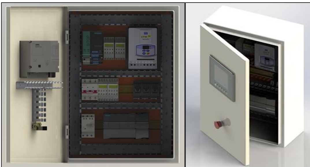
Figura 24-3: Dispositivos de red para el PLC y HMI Fuente: SILVA CONDE, Angel Alberto, 2016
