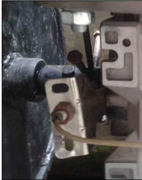
Figura 31-3: Sensor inductivo en la válvula mariposa Fuente: SILVA CONDE, Angel Alberto, 2016
