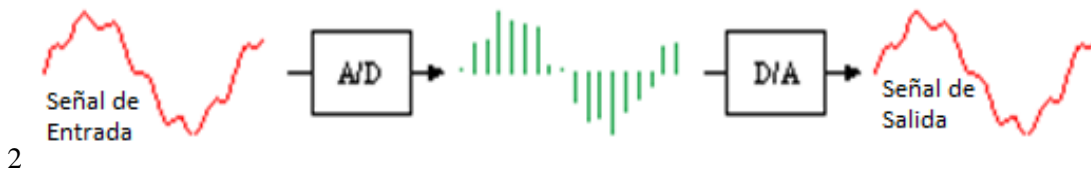
Figura 13.1.- Esquema muestreo de una señal Fuente: Jhon Jairo Cevallos, 2016
