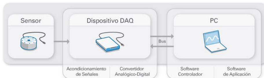
Figura 12.2. – Partes de un sistema DAQ Fuente: National Instruments
