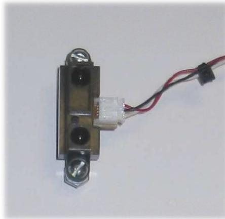
FIGURA III.5: Sensor de Proximidad infrarrojo
