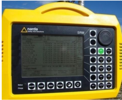
Figura V.5. Equipo Narda SRM 3000 40
