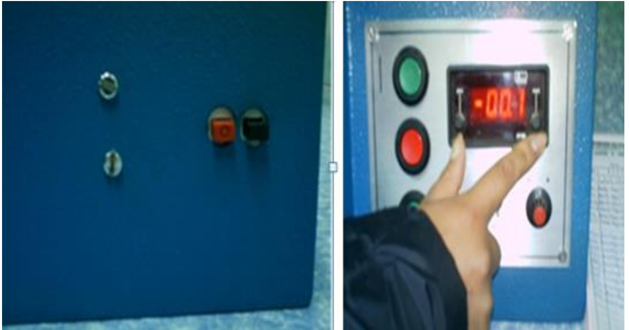
Figura 7. Encendido de la máquina de resistencia a la tensión el cuero.
