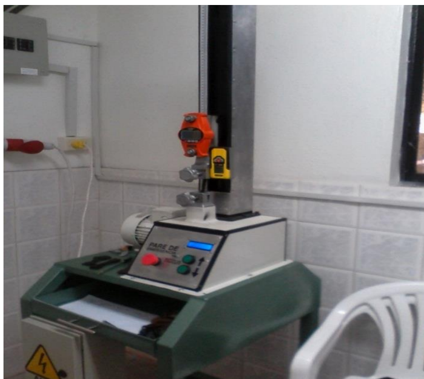
Figura 3. Máquina para medir las resistencias físicas del cuero
