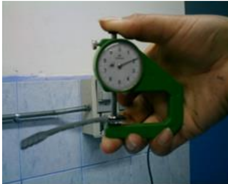
Gráfico 18. Equipo de medición del espesor del cuero.
