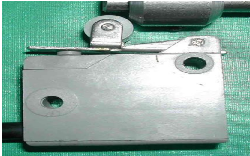
Gráfico 13. Sensor para medir el final de la carrera en una máquina prensadora.
