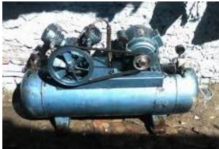
Gráfico 12. Compresor de aire (Motor de la máquina prensadora de cuero).
