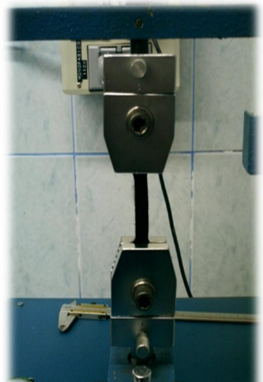
Fotografía 2. Medición de la resistencia a la tensión y porcentaje de elongación del cuero.
