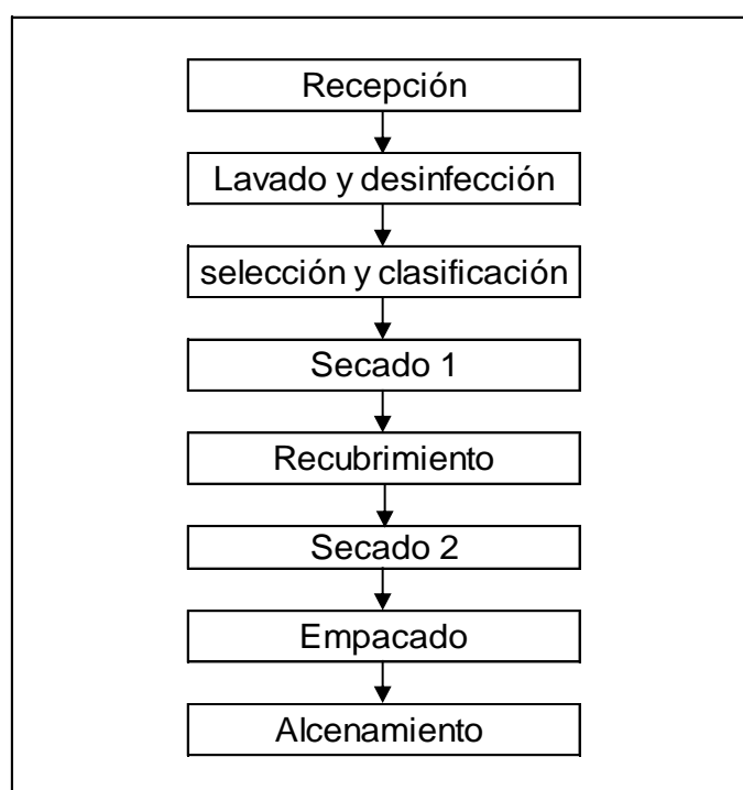
Gráfico 19. Diagrama de flujo de la aplicación de recubrimientos en la papaya.
