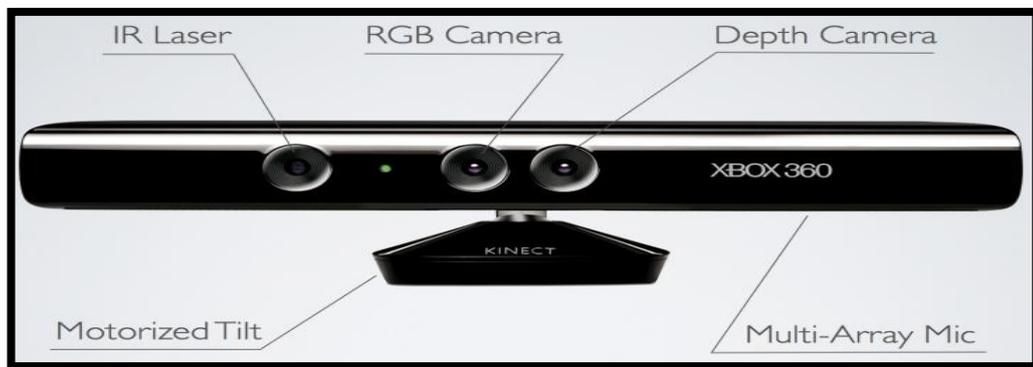
**Ilustración 9-1** Partes del kinect
