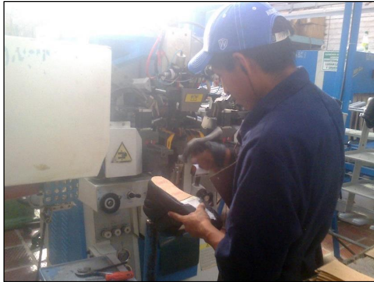
Ilustración 14-3: Armado de lados Realizado por: Santiago Aldás, 2016
