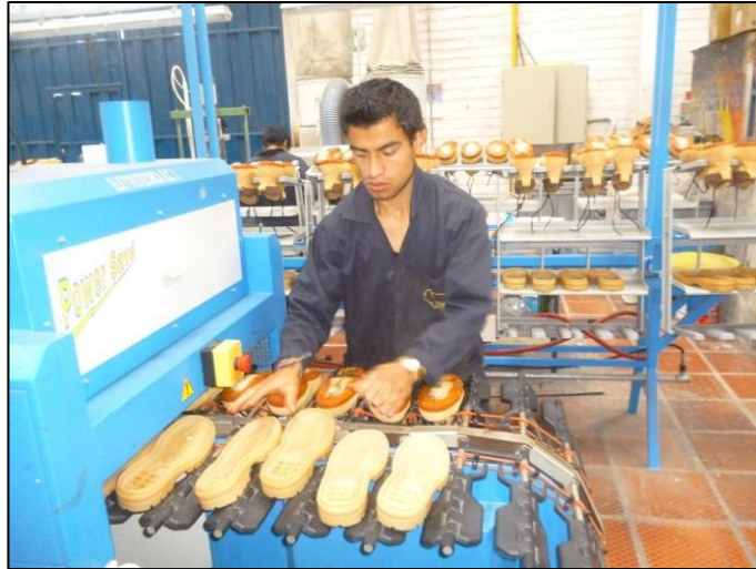
Ilustración 18-3: Reactivado de pega Realizado por: Santiago Aldás, 2016
