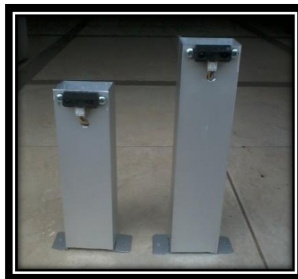
Figura 15-2: Acoplamiento de sensor Sharp.
