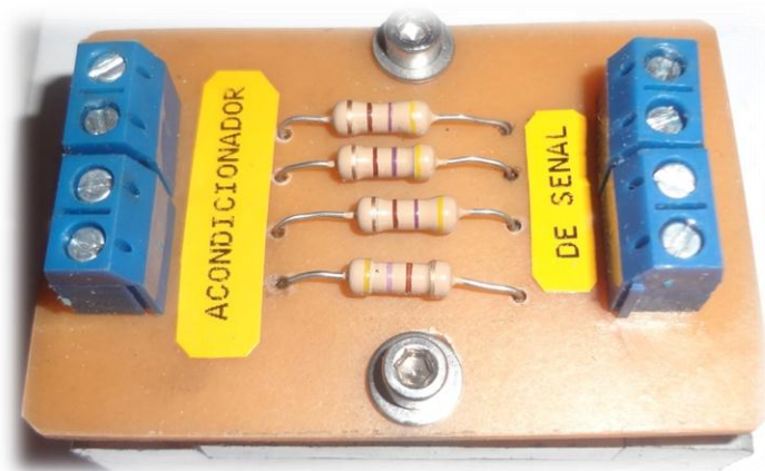
Figura 28-3. Tarjeta de acondicionamiento de señal Realizado por Aguilar Antonio
