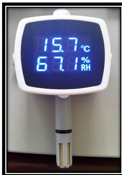
Figura 12-3 Sensor de Temperatura y Humedad. Realizado por: Arévalo V. y Anguisaca L. 2016.
