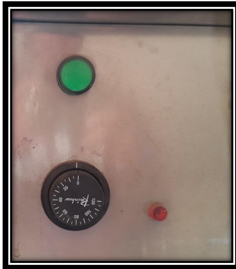
Figura 4-3 Luz indicadora de puesta en marcha. Realizado por: Arévalo V. y Anguisaca L. 2016.
