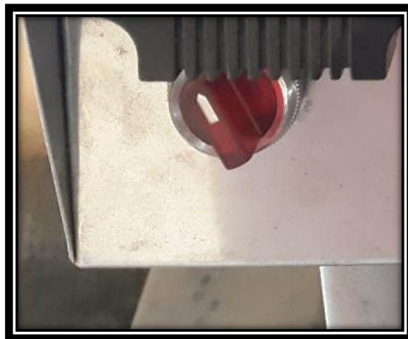
Figura 3-3 Selector puesta en marcha. Realizado por: Arévalo V. y Anguisaca L. 2016.
