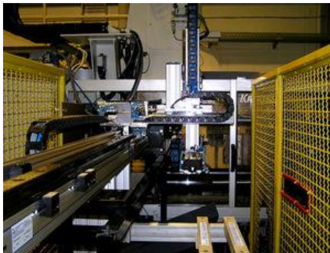
Figura 10-2 Tareas realizadas por cartesianos en la industria de ensamble. Fuente: http://img.directindustry.com/images_di/photo-m2/cartesian-robot-5-axis-extraction-injection-molding-machine-72624-8652249.jpg
