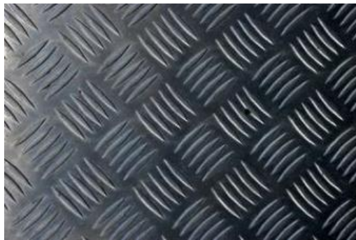
Figura III. 5: Plancha de acero negro 2mm antideslizante Fuente: http://www.freepik.es/fotos-vectores-gratis/placa-de-acero
