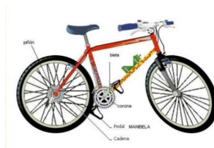
Figura II. 1: Bicicleta, ejemplo de un sistema mecánico.
