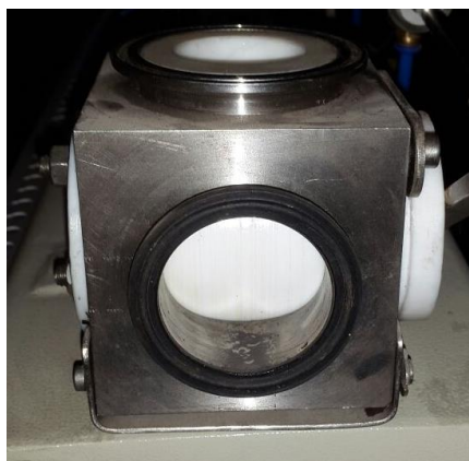
Figura III. 11: Válvula general de paso terminada Fuente: Autores
