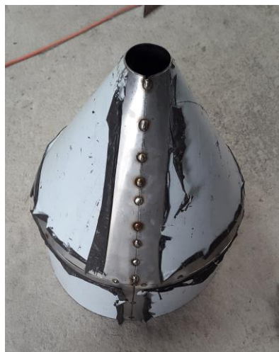
Figura III. 6 : Tolva de almacenamiento en construcción Fuente: Autores
