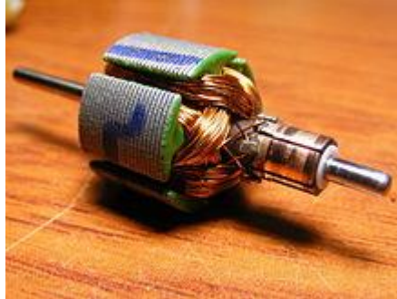
Figura II. 41: Rotor de un motor DC
