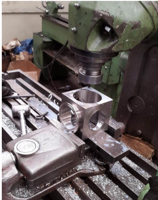
Figura III. 10: Parte fija de la válvula general de paso en proceso de torneado. Fuente: Autores
