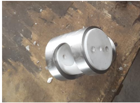
Figura III. 13: Válvula de paso del brazo de cobertura Fuente: Autores
