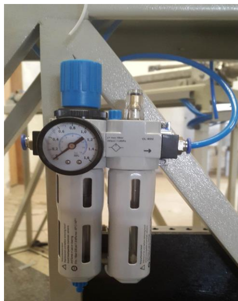
Figura III. 20: Unidad de Mantenimiento usada en este proyecto.
