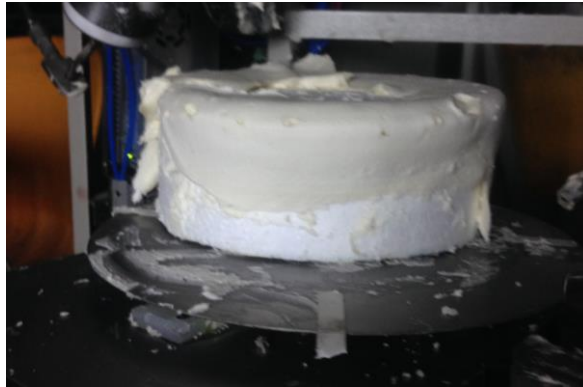
Figura IV. 5: Resultado, cuando la velocidad del cilindro está muy baja. Fuente: Autores
