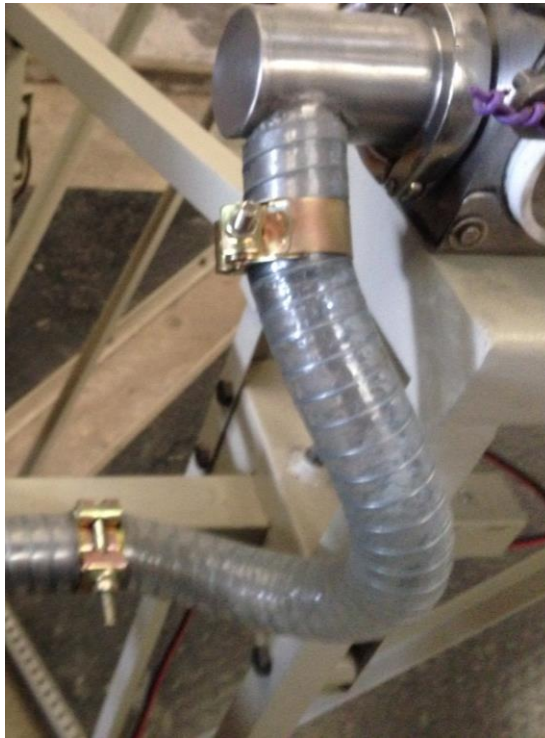
Figura III. 16: Manguera de transporte de crema Fuente: Autores
