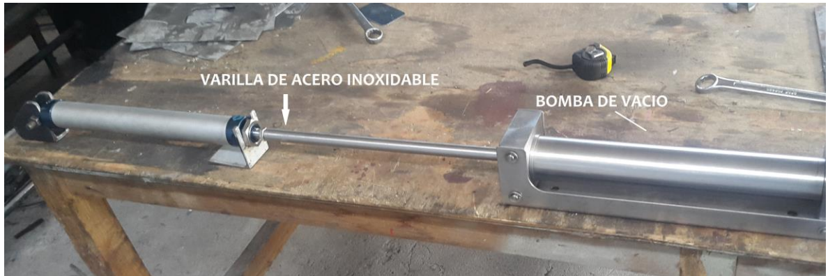
Figura III. 8: Bomba de vacío acoplada al cilindro neumático Fuente: Autores
