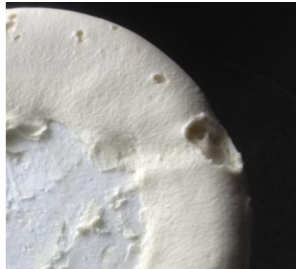
Figura IV. 2: Deformaciones causadas por ingreso de aire en la bomba recíprocante de la prueba N°1 de cobertura.
