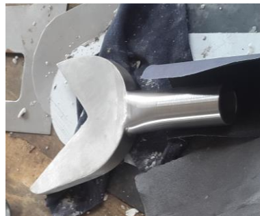
Figura III. 14: Boquilla de cobertura Fuente: Autores
