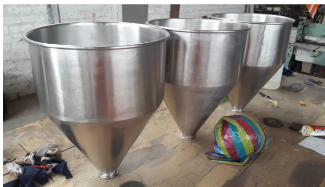
Figura III. 7: Tolvas de almacenamiento finalizadas Fuente: Autores
