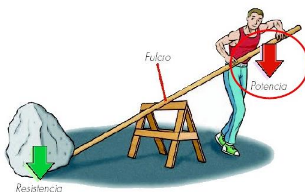
Figura II. 3: Elementos de una palanca
