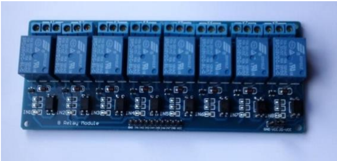
Figura III. 29: Módulos de relé de 8 canales.
