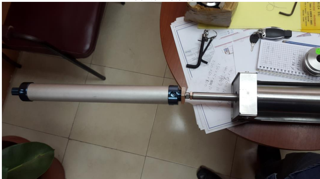
Figura III. 9: Acople de la varilla metálica de la bomba al vástago del cilindro neumático Fuente: Autores
