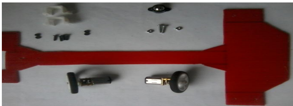
Figura 82-3 Velocista, base acrílica, micro motores, llantas, rueda loca y tornillos Fuente: Autores de tesis
