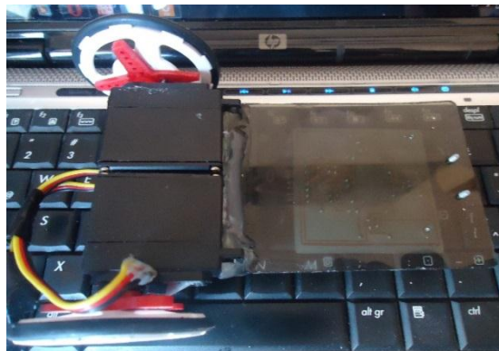
Figura 78-3 Seguidor de línea base acrílico, servos y llantas Fuente: Autores de tesis
