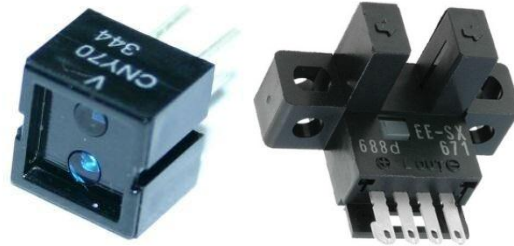
Figura 32-1 Sensores ópticos CNY70 y EE-SX67
