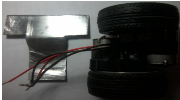
Figura 84-3 Mini sumo, base de aluminio, motores con llantas Fuente: Autores de tesis
