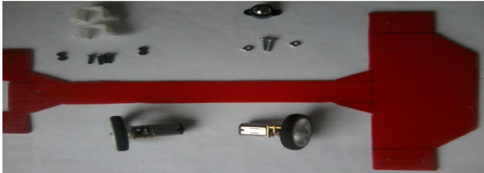
Velocista, base acrílica, micro motores, llantas, rueda loca y tornillos
