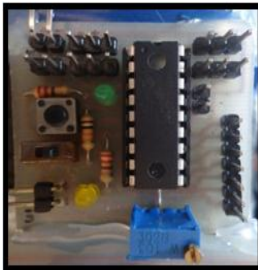
Módulo Cerebro con el Pic 16F628A
