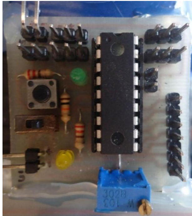
Figura 42-2 Placa Impresa (16F628A) Fuente: autores de tesis
