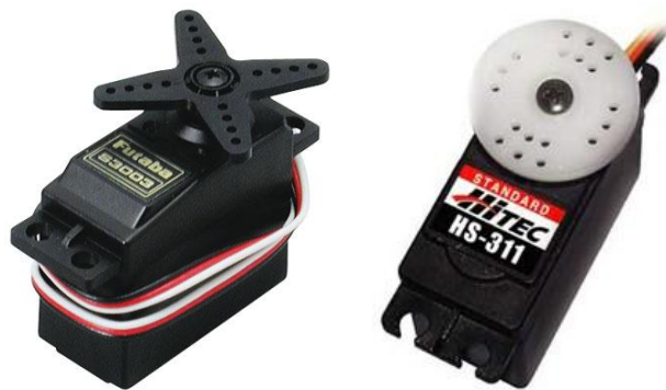
Figura 13-1 Servomotor Futaba y Hitec 311 Fuente: http://roboticasunyer.blogspot.com/
