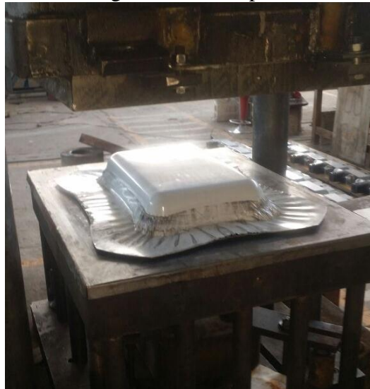
Figura 87. Arrugamiento en la pestaña del molde
