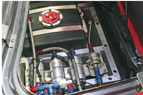
Figura 7. Sistema de alimentación en vehículos de competencia
