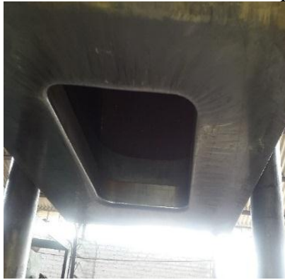
Figura 84. Ubicar la matriz de absorción en la prensa hidráulica
