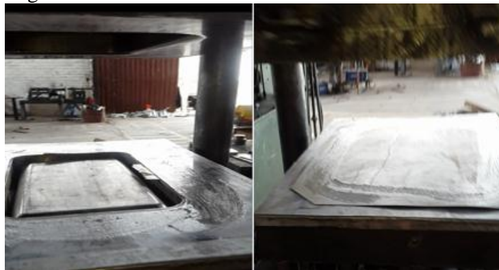
Figura 85. Lubricación de la lámina de acero inoxidable
