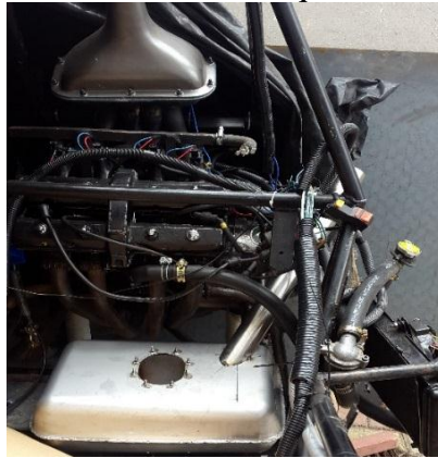
Figura 79. Ubicación del tanque de combustible
