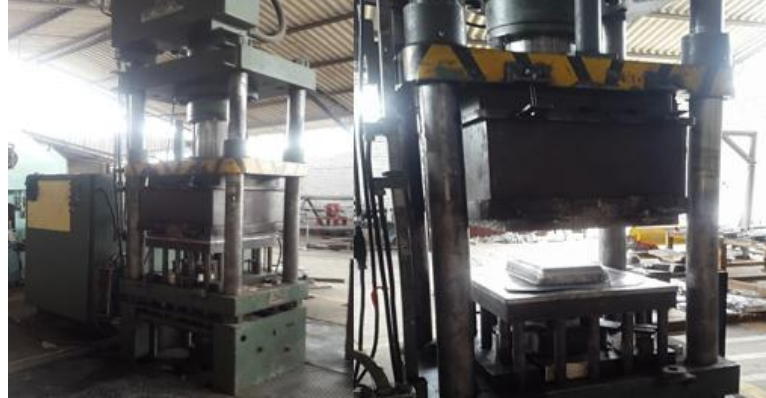
Figura 86. Embutido de la pieza con la prensa hidráulica
