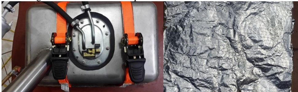
Figura 97. Forrado del tanque de combustible con tela térmica
