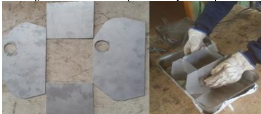
Figura 90. Corte del compartimiento y los rompeolas
