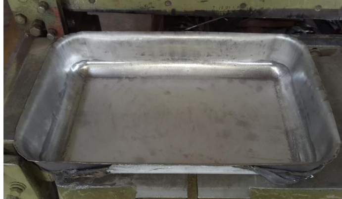
Figura 88. Pulido del molde después del proceso de embutición
