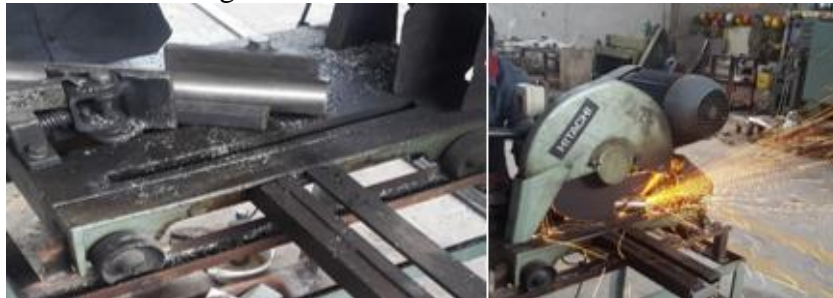
Figura 94. Corte del tubo de llenado
