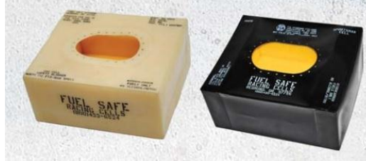
Figura 4. Tanques de combustible en la F1.
