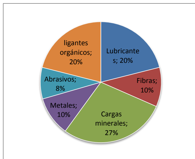
Figura 17. Esquema de composición de material de las pastillas.
