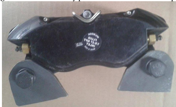
Figura 60. Construcción y prueba de las bases de los calipers.
