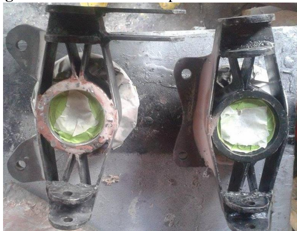
Figura 62. Pulido de las superficies de soldadura.
