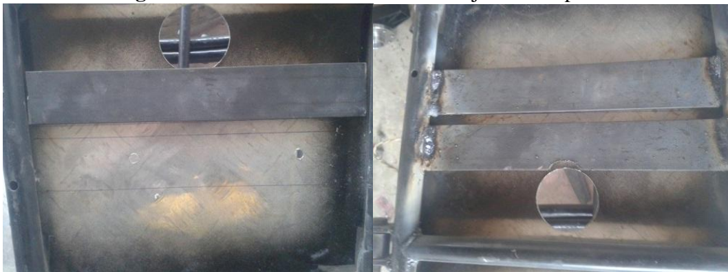
Figura 53. Construcción de la base de fijación del pedal.
