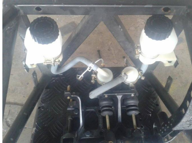
Figura55. Ubicación de los reservorios hidráulicos.
