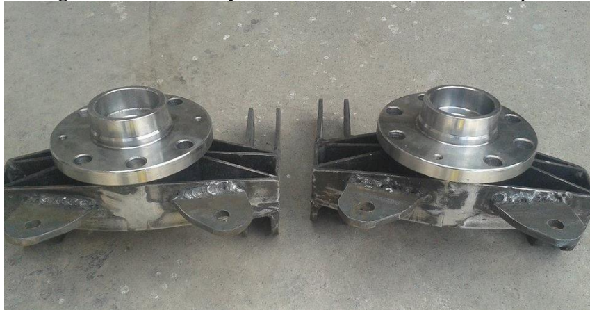
Figura 61. Centrado y soldado de las bases de los calipers.
