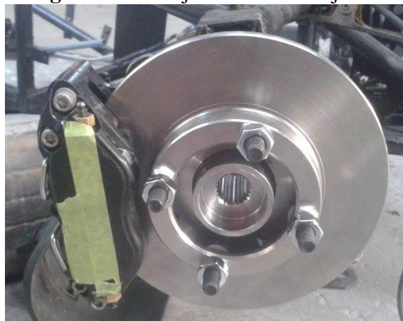
Figura 64 Anclaje de todo el conjunto.
