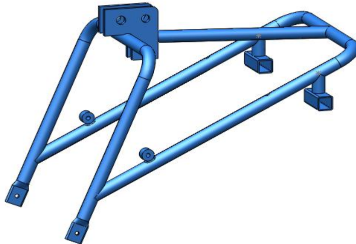
Figura 37. Estructura del soporte de la cuchilla del sistema de excavación de papas
