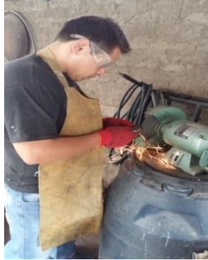
Figura 52. Esmerilado de la placa soporte
