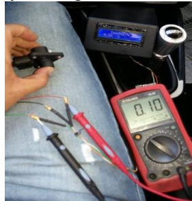
Figura 74. Voltaje y %desgaste simulando pastillas nuevas
