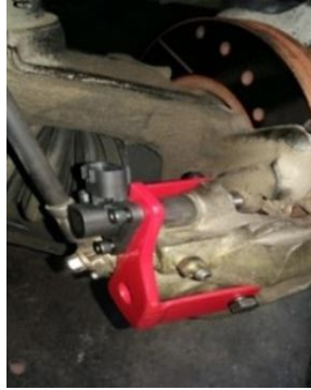
Figura 57. Adecuación de la mordaza de freno
