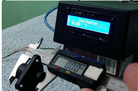
Figura 42. Simulación de pastillas sin desgaste
