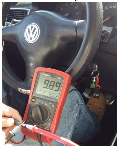
Figura 69. Verificación de voltaje 3 de alimentación
