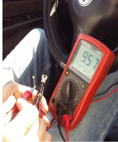
Figura 66. Voltaje 2 emitido por el regulador
