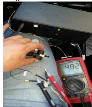
Figura 73. Voltaje de alimentación del sensor
