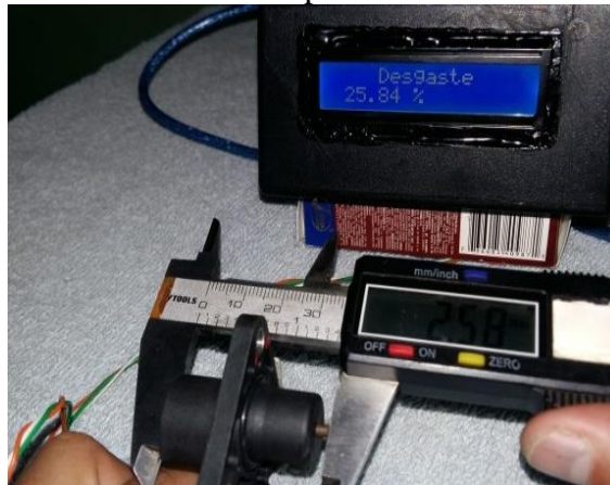
Figura 43. Simulación de pastillas con 25 % desgaste
