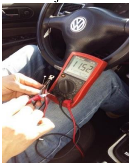
Figura 63. Voltaje de alimentación 1
