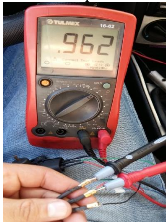
Figura 70. Resistencia en el pin B de señal del sensor
