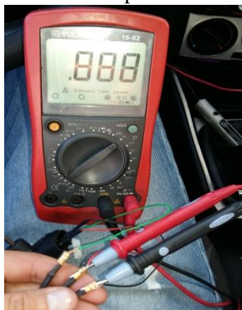
Figura 71. Resistencia en el pin C de masa del sensor
