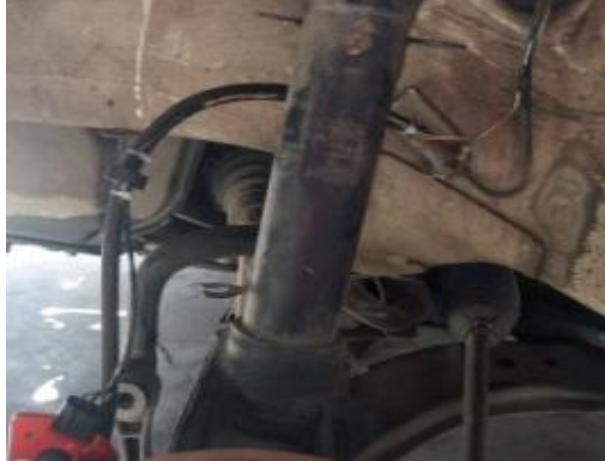
Figura 36. Tendido del cableado del sistema incorporado
