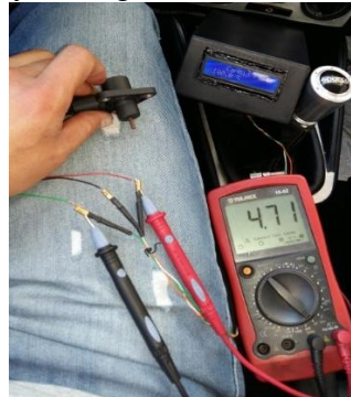
Figura 76. Voltaje y %desgaste simulando pastillas de cambio
