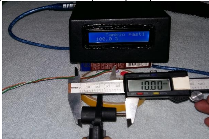
Figura 45. Simulación de pastilla que requiere ser cambiada
