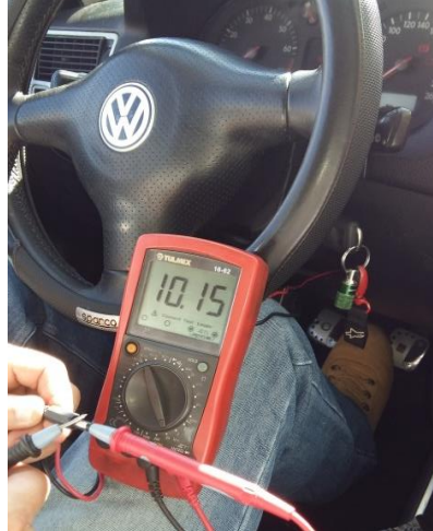
Figura 68. Verificación de voltaje 2 de alimentación
