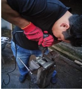
Figura 47. Modificación de la mordaza de freno
