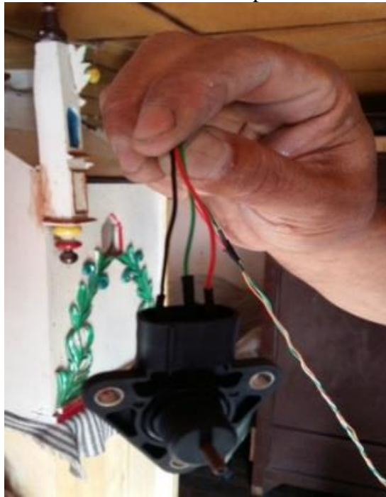
Figura 31. Pines de conexión del sensor de posición de la válvula EGR
