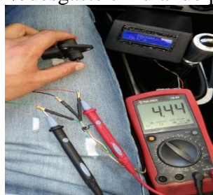
Figura 75. Voltaje y %desgaste simulando pastillas con desgaste
