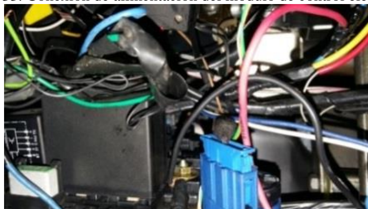
Figura 33. Conexión de alimentación del módulo de control electrónico
