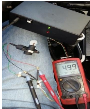
Figura 72. Voltaje de alimentación del sensor
