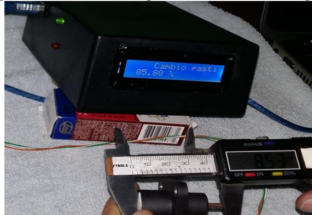
Figura 44. Simulación de pastillas con 85 % de desgaste
