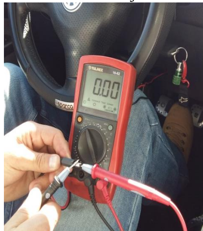
Figura 67. Verificación de voltaje 1 de alimentación
