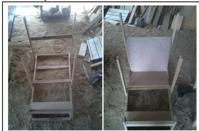
Figura 60. Mock-up de la estructura metálica del vehículo en madera
