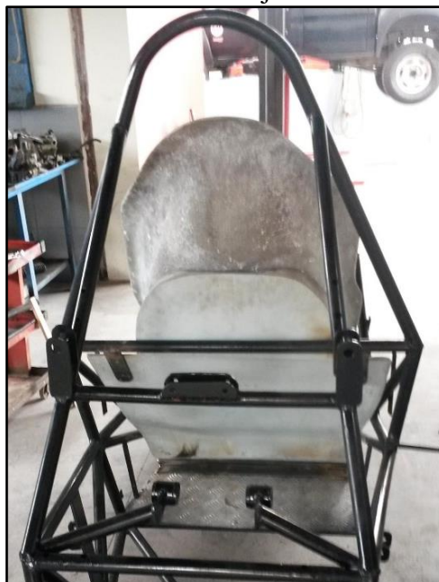
Figura 79. Bases de anclaje soldadas el chasis
