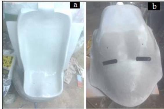
Figura 74.a) Firewall, b) Asiento ergonómico con fondo automotriz
