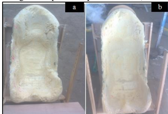
Figura 62. a) Molde frágil en espuma de poliuretano, b) Molde reforzado con yeso
