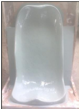
Figura 70. Mock-up del firewall recubierta con una capa de gel antiadherente
