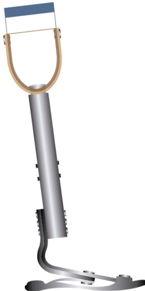
Figura 2.2. Boceto de prótesis endoesquelética.
