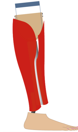
Figura 9-2. Boceto inicial de prótesis exoesquelética.
