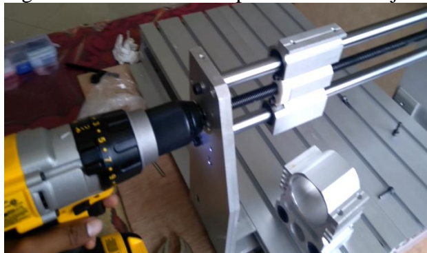
Figura 118 Pruebas de desplazamiento del eje X.
