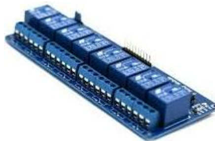
Figura 18. Banco de relay.
