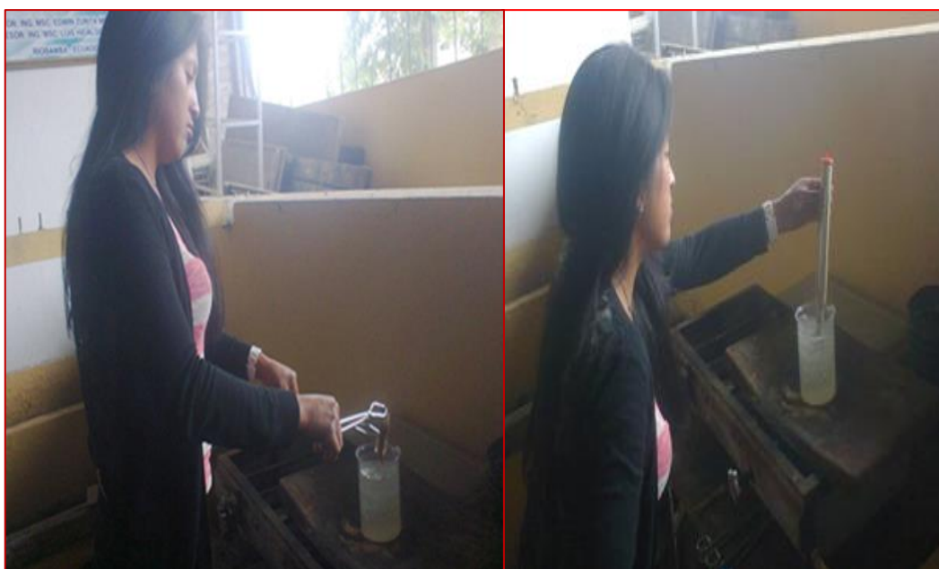
Fotografía 9. Determinación de la temperatura de encogimiento del cuero.
