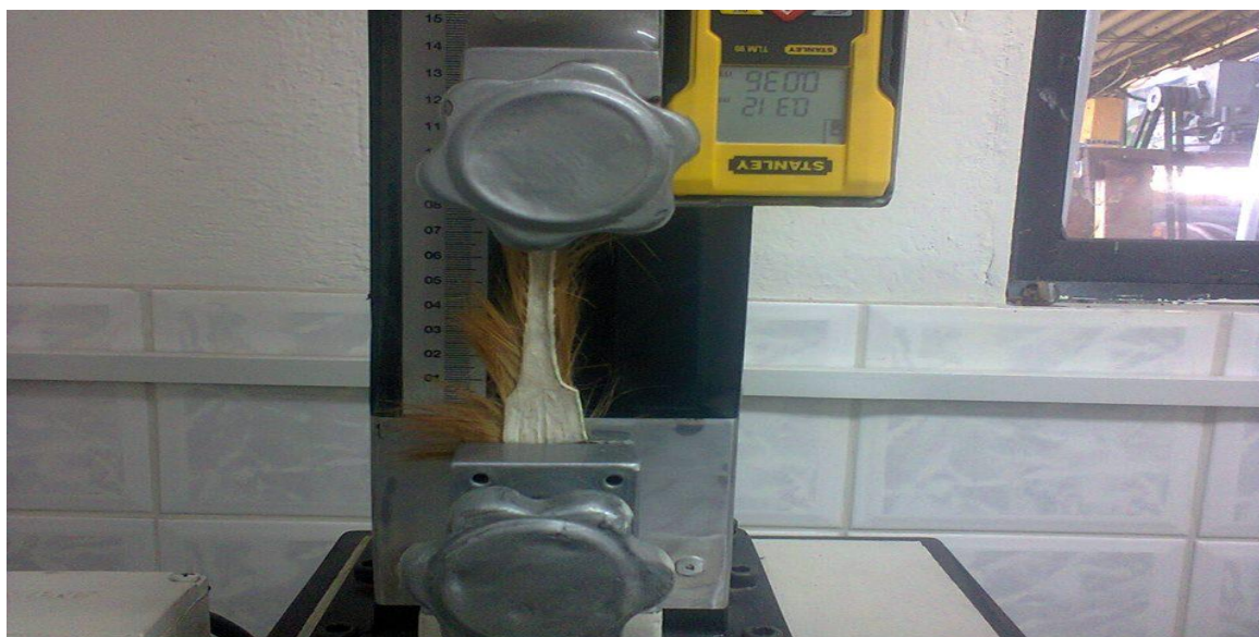
Fotografía 3. Equipo para realizar la medición de la resistencia a la tensión.
