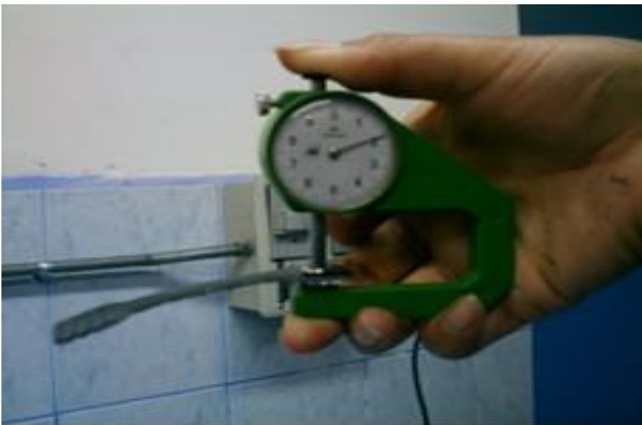
Fotografía 4. Equipo para medir el calibre del cuero.
