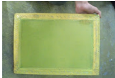
Ilustración 22-1: Sellado de la malla
