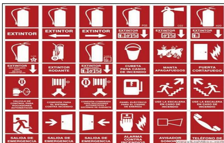
Figura 8. Señales de información de lucha contra incendios.
