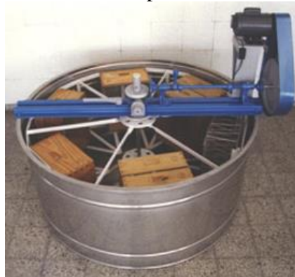
Figura 11. Extractor paralelo radial de miel
