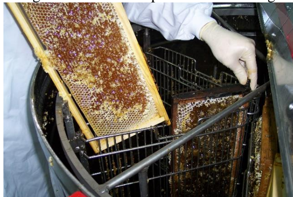
Figura 7. Extracción por fuerza centrífuga
