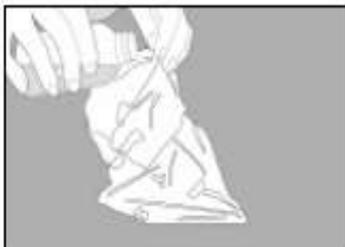
5 Adicione la cantidad apropiada de uno de los siguientes diluyentes estériles: tampón Butterfield (tampón IDF fosfato, 0.0425 g/L de  $\text{KH}_2\text{PO}_4$  y con pH ajustado a 7.2); agua de peptona al 0.1%; diluyente de sal peptonada (método ISO 6887); buffer de agua de peptona (método ISO 6579); solución salina (0.85 a 0.90%); caldo letheen libre de bisulfato o agua destilada.
