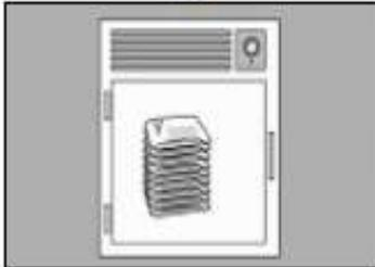
1 Almacene los paquetes cerrados a una temperatura  $\leq 8^{\circ}\text{C}$  ( $\leq 46^{\circ}\text{F}$ ). Las placas deben usarse antes de su fecha de caducidad. En áreas de alta humedad, donde la condensación puede ser un inconveniente, es recomendable que los paquetes se atemperen al ambiente del lugar de trabajo antes de abrirlas. Las Placas Petrifilm tienen un tiempo de vida útil de 18 meses desde su fecha de elaboración. Observe la fecha de caducidad en la parte superior de la placa.
