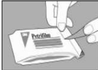
2 Para cerrar un paquete abierto, doble el extremo y sellelo con cinta adhesiva para evitar el ingreso de humedad y, por lo tanto, la alteración de las placas.
