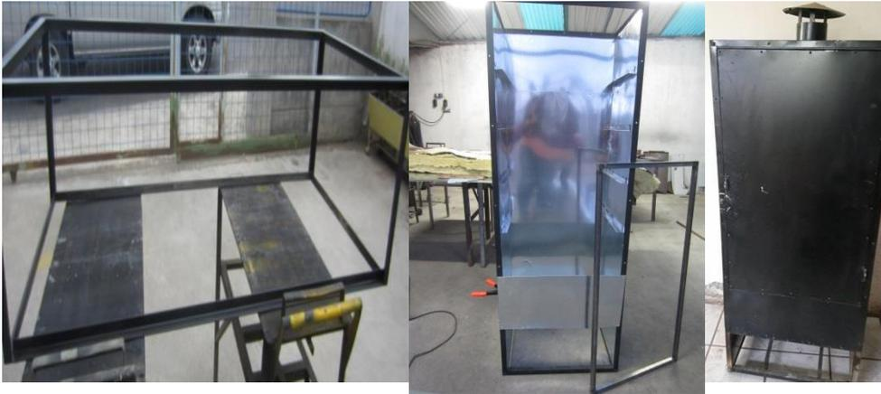
Fotografía 1: Construcción del ahumador
