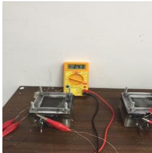
Fotografía 2-14 Instalación Eléctrica de la Celda Combustible Microbiano
