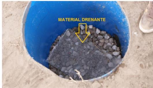
**Figura 2-2. Fabricación del lisímetro.**
