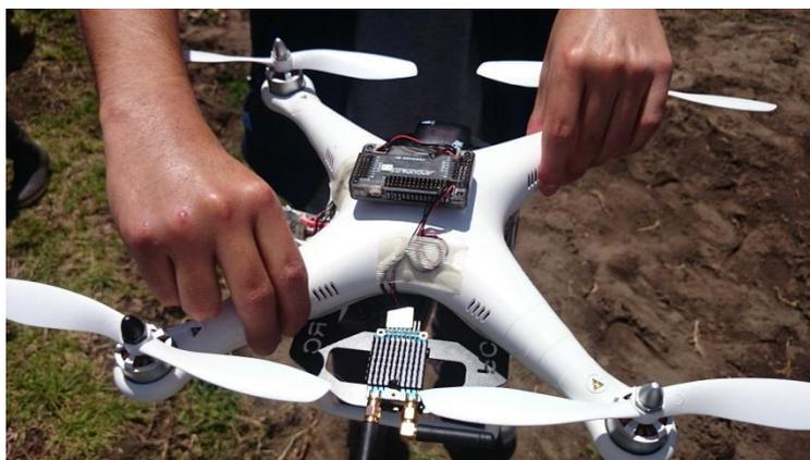
**Figura 1-2.** Cuadricóptero de mediana autonomía equipada con una cámara RGB modificada con un filtro para captar el infrarrojo.
