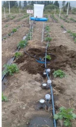
**Figura 4-2. Tensiómetros colocados junto al lisímetro**
