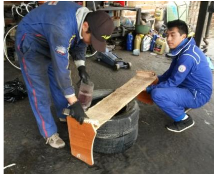
Figura 96. Colocación de las láminas de cabuya
