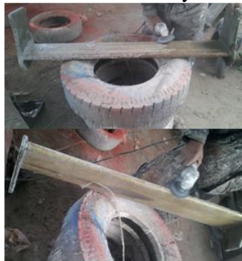
Figura 99. Pulido de la fibra de cabuya en el spoiler y alerón
