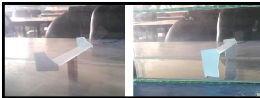
Figura 78. Simulación del spoiler delantero y alerón posterior en el túnel de viento
