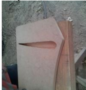
Figura 91. Perforación para el montaje de las derivas laterales
