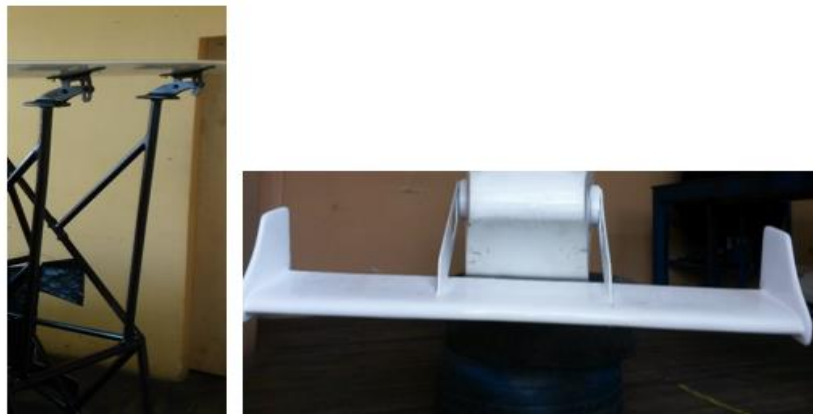
Figura 106. Soporte del spoiler y alerón ubicados en la carrocería
