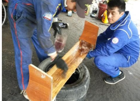
Figura 95. Colocación de la resina
