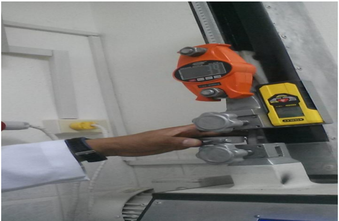
Fotografía 3. Esquema del equipo de medición de la resistencia a la tensión del cuero.
