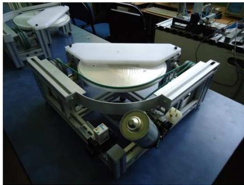
**Fig. V.43.Vista lateral del codo de Giro 90°**
