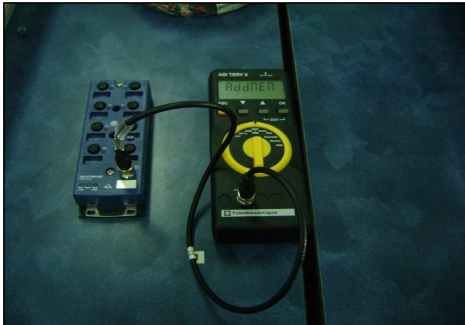
Figura VI.44. Configuración del Esclavo ASI-BUS mediante ASITERV2.
