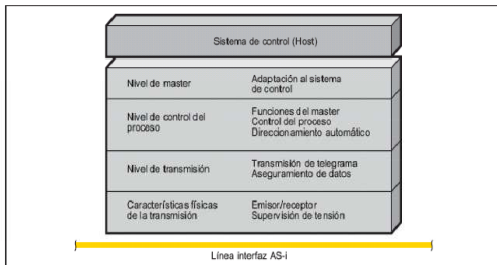
Figura IV.27 Estructura del maestro AS-i. 29
