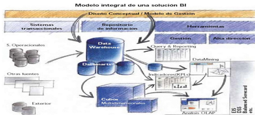
Figura No. 1. Arquitectura Solución BI tradicional Fuente: (Ibermática, 2007)
