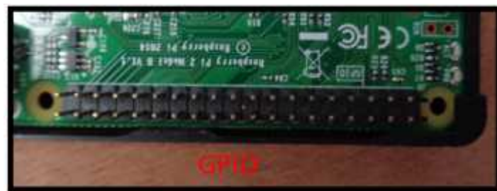
Figura 2-17 Puerto GPIO del RPi Fuente Calle O., Santamaría G. (2016).
