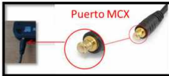
Figura 2-19 Puerto MCX del decodificador. Fuente Calle O., Santamaría G. (2016).
