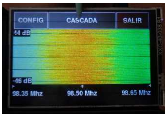
Figura 3-23 Diagrama en cascada de la señal. Fuente: Calle O., Santamaría G. (2016).
