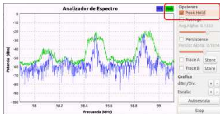
Figura 3-34 Activación del Peak Hold en Ubuntu. Fuente: Calle O., Santamaría G. (2016).
