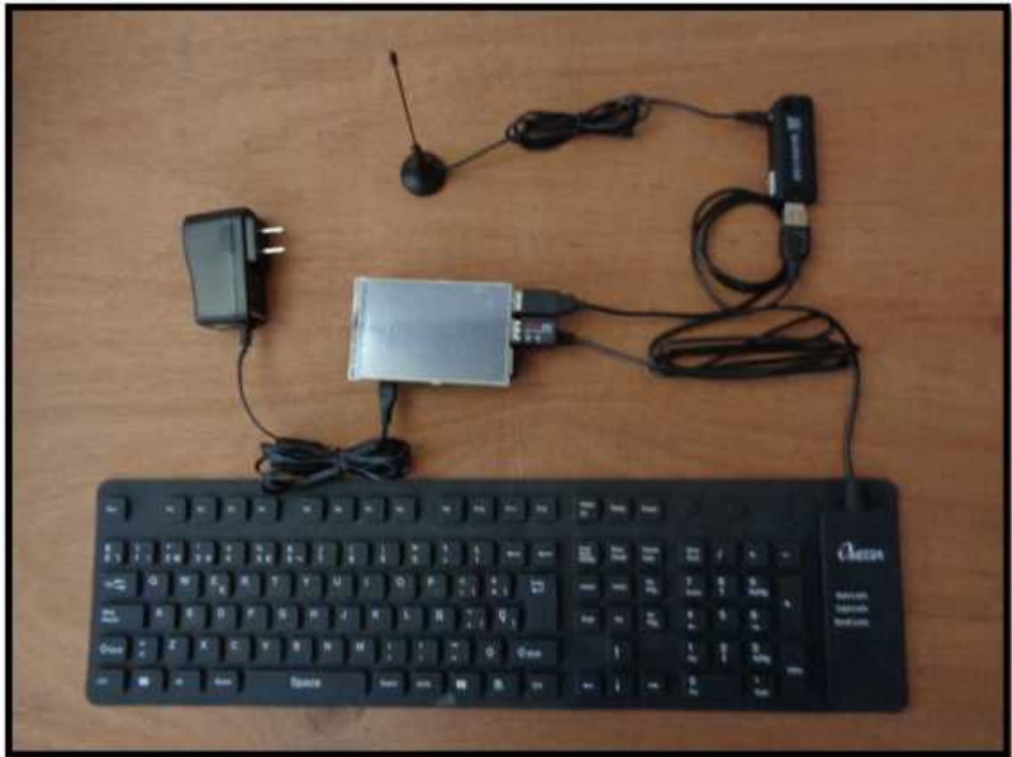
Figura 2-21 Componentes del analizador de espectro. Fuente Calle O., Santamaría G. (2016).
