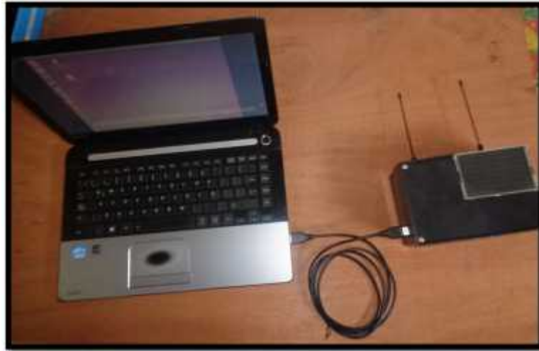
Figura 3-30 Conexión entre analizador de espectro y PC. Fuente: Calle O., Santamaría G. (2016).
