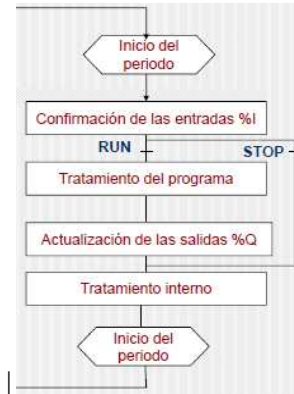
Figura. II.40. Ejecución periódica del PLC
