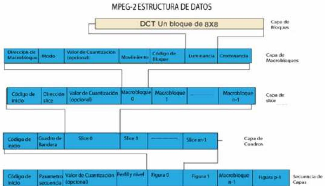
**Figura 9-1.** Estructura de la Trama MPEG-2.
